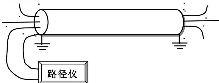
接线法 1 路径仪红接线接电缆的一相，黑接线柱接电缆的地
