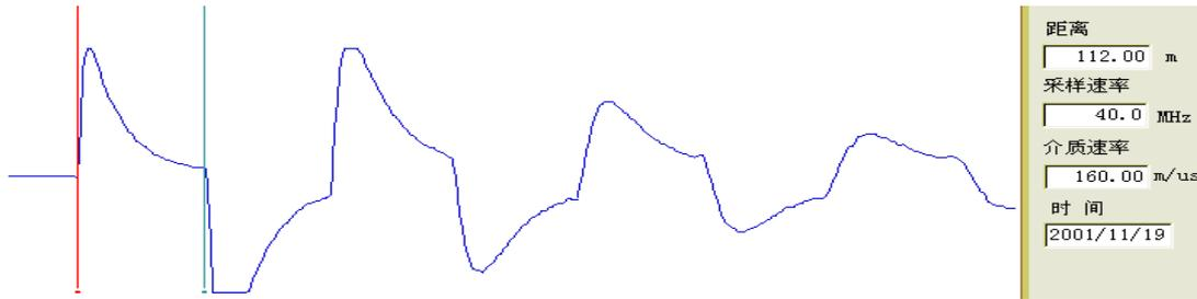
短路故障测试波形
