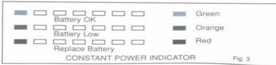
另一种为电池测试状态。按下电池测试键进行电池测试。测试时光二极管以三色图谱指示电池的实际电压。（见图4）
