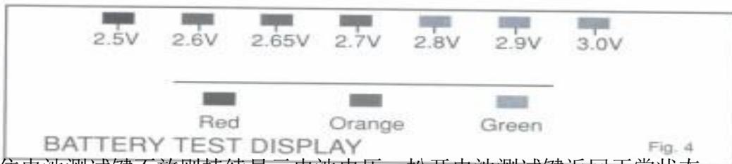
若按住电池测试键不放则持续显示电池电压。松开电池测试键返回正常状态。
