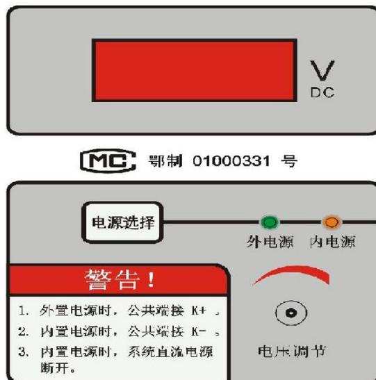
开机后可请选择内电源或外电源,如选择内电源触发则由本仪器合闸控制或分闸控制提供正电源,公共端提供负电源(如上图),如选择外电源则本仪器不提供电源,而由外部提供电源。
