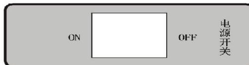
请用本公司提供的电源线连接到仪器侧面的电源插口,打开电源开关仪器便可以正常工作,如连接好后仪器不能工作请检查保险丝。
