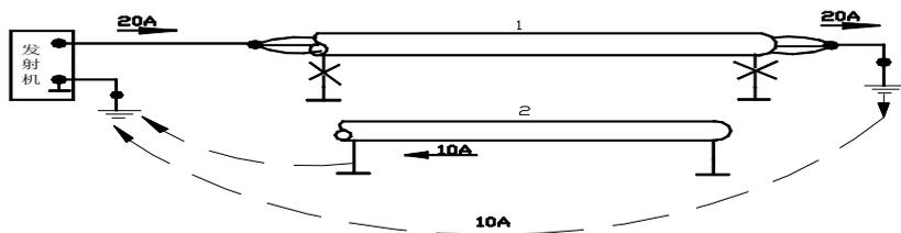
图 7 将电缆屏蔽层与系统地断开
