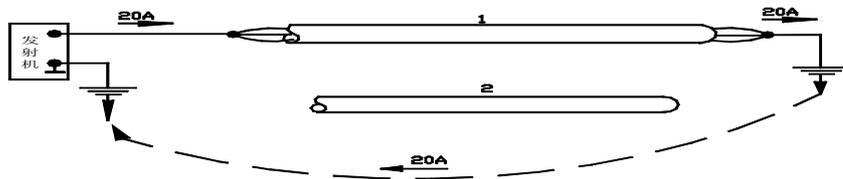
图 8 通过地钉的回电路
