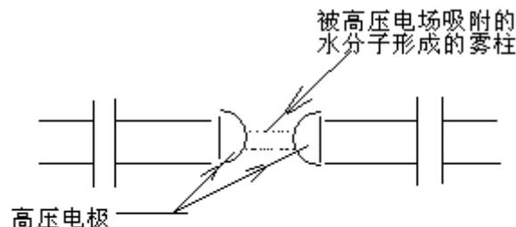
图1 雾柱和杂质构成导电
