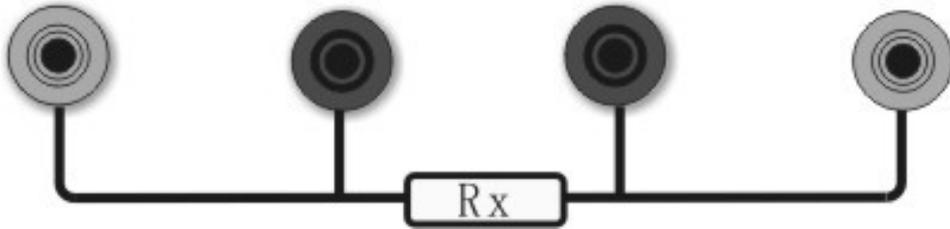
输入输出接线端子如上图所示，共 4 只接线柱，其中外侧两只红色接线柱为电流输出，内侧两只接线柱为测量电压采样输入。
