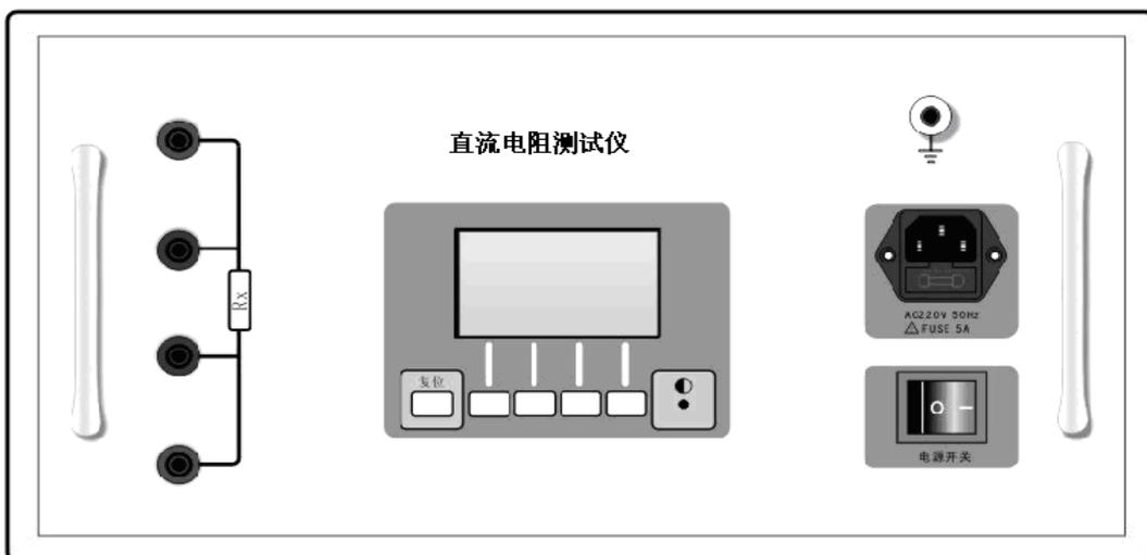
直阻仪的面板布局如上图所示，包括液晶显示器、键盘、电源插座和电源开关以及接线端子、接地端子。
